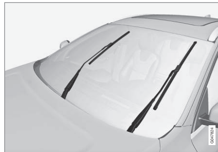
Pióra wycieraczek w pozycji serwisowej.
