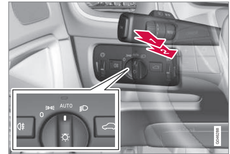
Lenkradhebel und Drehregler des Lichtschalters.
