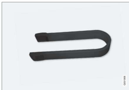
Szerszám a keréksavarok műanyag sapkáinak eltávolításához.
