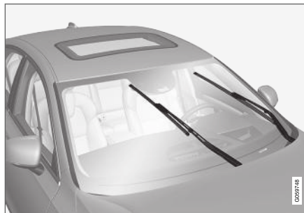
Escobillas de limpiaparabrisas en posición de servicio.
