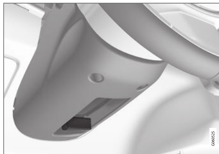
Palanca de regulación del volante.
