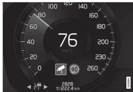
Información sobre cámaras de control de velocidad en la pantalla del conductor.
