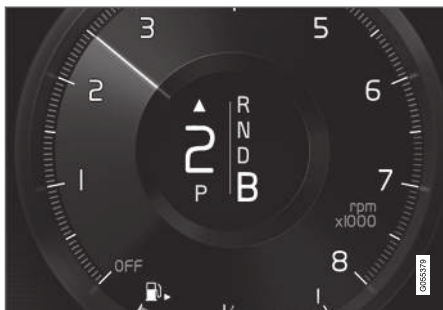
Indicador de cambio de marcha en la pantalla del conductor 5 .
