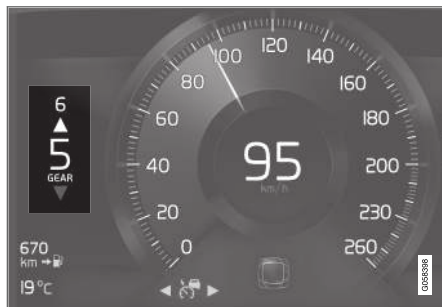
Gearskift-indikator på 8-tommer førerdisplay.
