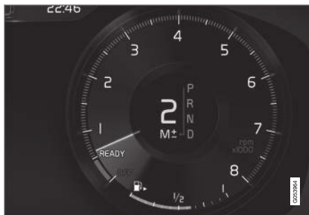
Manuel gearposition på førerdisplayet 3 .
