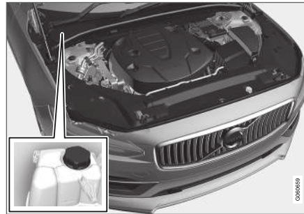
Ekspansionsbeholder for kølesystemet, højrestyret bil.
