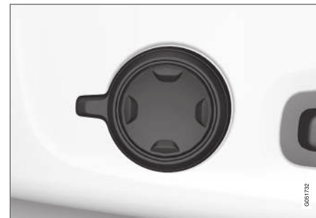
Multifunktionsknappen, placeret på siden af sædets sidedel.
