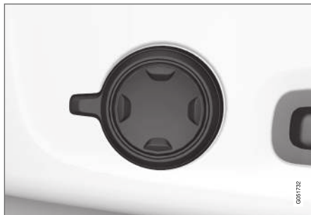
Multifunktionsknappen, placeret på siden af sædets sidedel.
