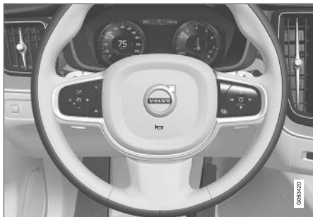
Hornet sidder midt på rattet.
