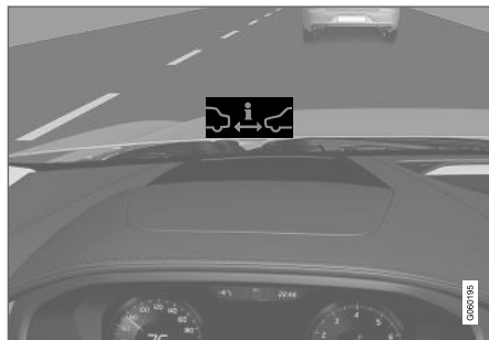
Symbol på forruden for afstandskontrol 36 .
