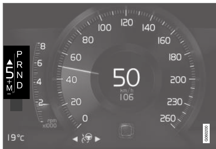
Gearskift-indikator på 8-tommer førerdisplay.
