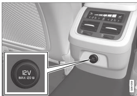
12 V-stikkontakt i tunnelkonsol, bagsæde.
