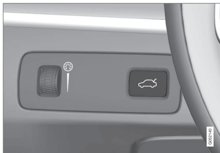
Knap til åbning/lukning på instrumentpanelet.
