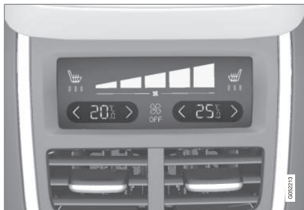
Temperaturknapper på klimapanelet bag på midterkonsollen.
