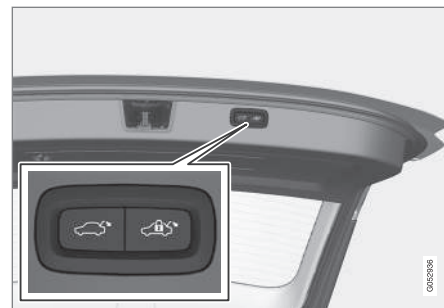
Knap til lukning og låsning på bagklappens underside.
