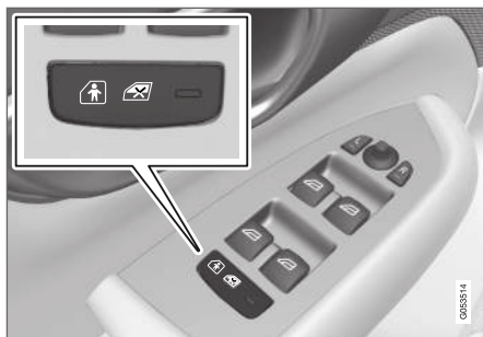
Pulsante di attivazione e disattivazione elettrica.
