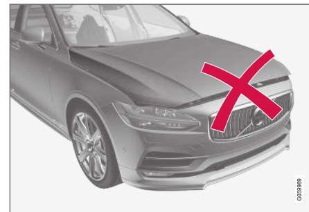
Cofano non completamente chiuso.
