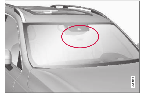
Posizione del gruppo radar.
