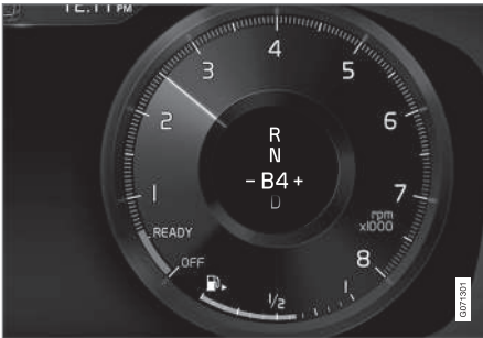
Juhiekraan käikude vahetamisel roolilabadega (manuaalse käiguvahetuse režiim).
