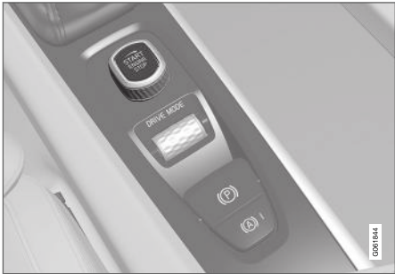
Startvredet i tunnelkonsolen.
