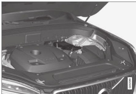
Stödbatteriet är placerat i en box bredvid fjäderbenstornet.
