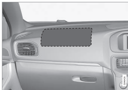
Plassering kollisjonspute på passasjersiden i bil med høyretått.
