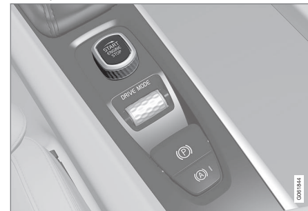
Disco de arranque na consola de túnel.
