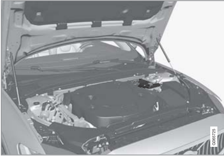
แบตเตอรี่เสริมจะติดตั้งอยู่ในห้องเครื่องยนต์
