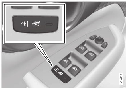
Pulsante di attivazione e disattivazione elettrica.
