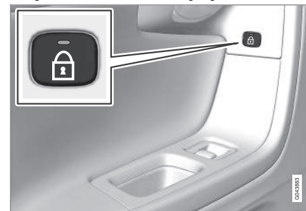
Lampka kontrolna w przycisku świeci się, gdy drzwi są zablokowane.
