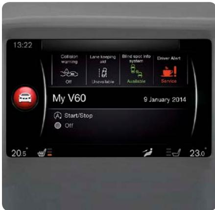
In MY CAR werden viele Funktionen des Fahrzeugs bedient, z. B. Einstellungen zu Uhr, Außenspiegeln und Verriegelung.
