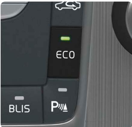
Ein Druck auf die Taste **ECO** aktiviert ein hinsichtlich des Kraftstoffverbrauchs optimal abgestimmtes Fahrprogramm mit u. a. folgenden Änderungen:
