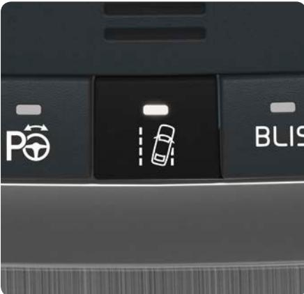
Wenn das Fahrzeug im Begriff ist, einen Seitenstreifen zu überfahren, wird das LKA aktiv eingreifen und durch einen schwachen Andrehen des Lenkrads auf die Fahrbahn zurücksteuern. Wenn das Fahrzeug einen Seitenstreifen überfährt, wird das LKA eine Warnung mit pulsierenden Vibrationen im Lenkrad ausgeben.
