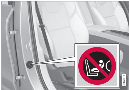
Juhi kõrvalistuja uksepilariil olev silt. Turvapadja silt on nähtav juhi kõrvalistuja ukse avamisel.
