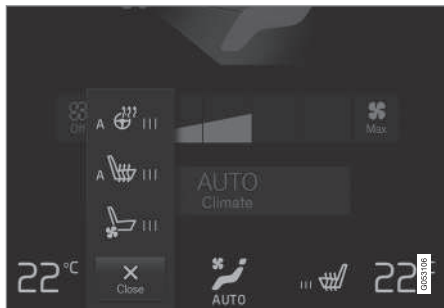
Przyciski kierownicy i foteli w wierszu klimatyzacji.
