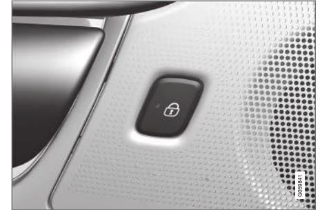
Verriegelungstaste mit Anzeigeleuchte an der Hintertür.
