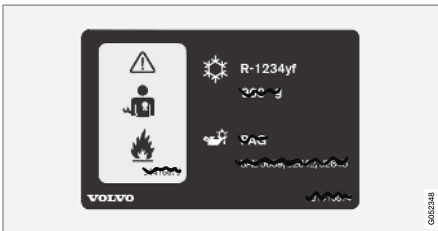
2 Aufkleber für Klimaanlage mit Kältemittel R1234yf.
