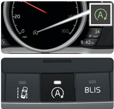
**Arrêt automatique :** Freiner jusqu'à l'arrêt du véhicule et maintenir la pédale de frein enfoncée.
