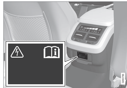
Strømuttak i tunnelkonsollen i baksetet.
