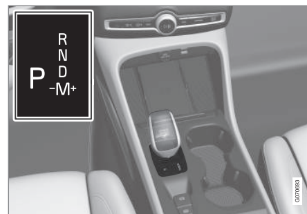
Oversikt over liten girspak og girskiftmønster i førerdisplayet
