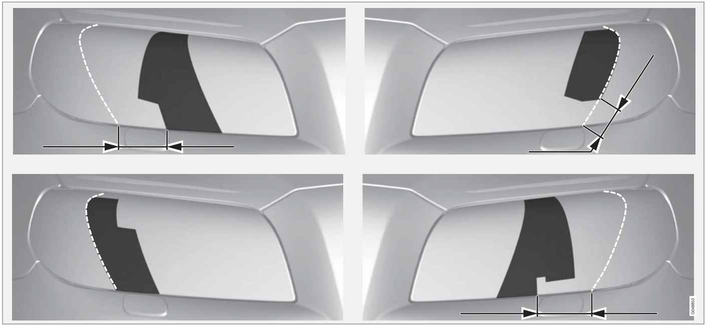
السهم العلوي: السيارات ذات عجلة القيادة اليسرى، القالبين A و B. السهم السفلي: السيارات ذات عجلة القيادة اليمنى، القالبين C و D.
