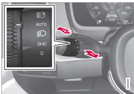
Palanca del volante con mando giratorio.
