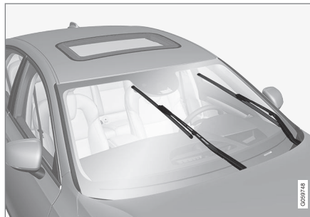
Escobillas de limpiaparabrisas en posición de servicio.
