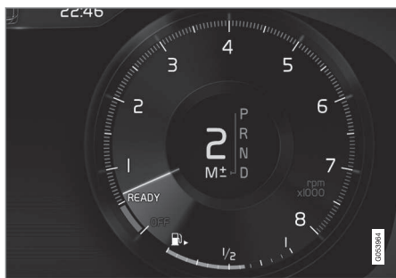
Modo de cambio manual en la pantalla del conductor 2
