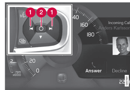
Mensaje en la pantalla del conductor 4 y teclado derecho del volante.
