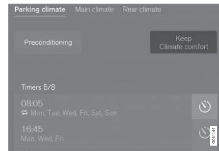
Botón de mantenimiento de la temperatura de confort en la pestaña Aparcamiento de la vista de climatización.
