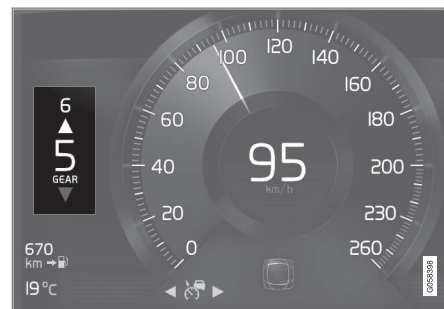
Indicador de cambios en la pantalla del conductor de 8 pulgadas.
