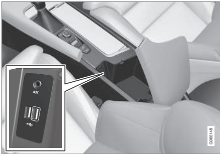
Conexión USB en la consola del túnel.
