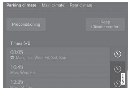
Botones de los temporizadores en la pestaña Aparcamiento de la vista de climatización.
