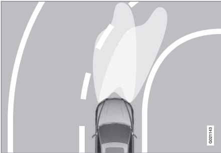
Haz luminoso con la función desconectada (izquierda) y conectada (derecha).
