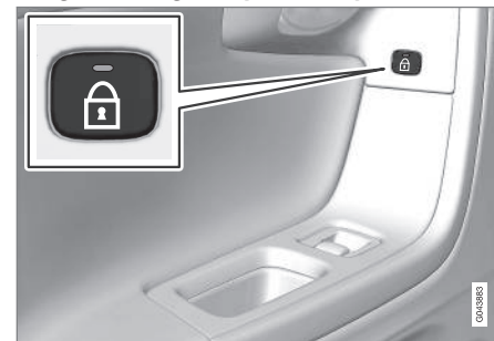
Bij een vergrendeld portier brandt het lampje in de knop.
