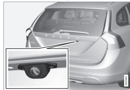
Cameraspositie bij de openingshandgreep.
