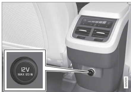
2열 좌석 터널 콘솔의 12V 전원 소켓.
