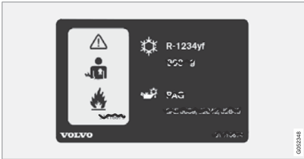
2 냉매 R1234yf를 사용하는 차량의 A/C 시스템 스티커.
