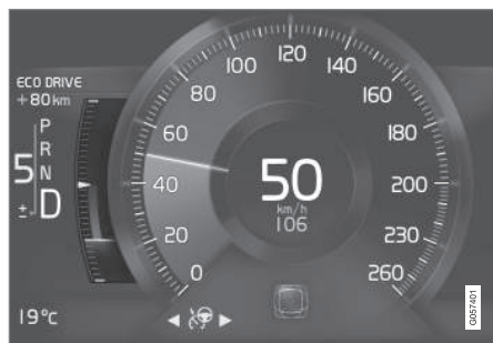
Eco műszer a 8-hüvelykes járművezetői kijelzőn.
