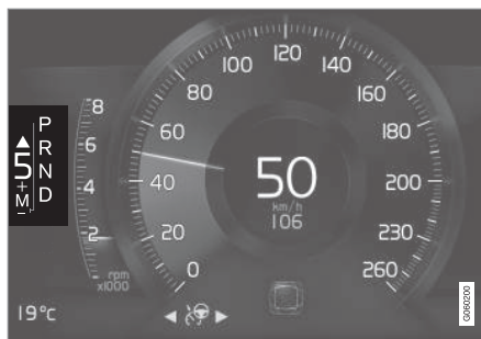
Fokozatváltás-jelző a 8-hüvelyes járművezetői kijelzőn.
