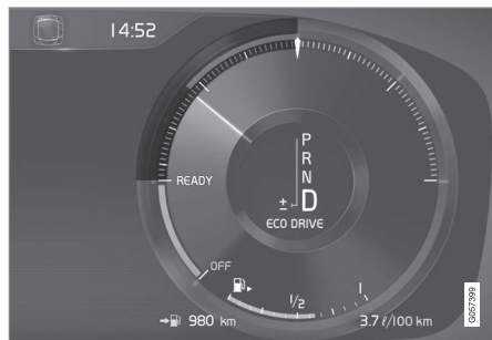
Eco műszer a 12-hüvelykes járművezetői kijelzőn.
