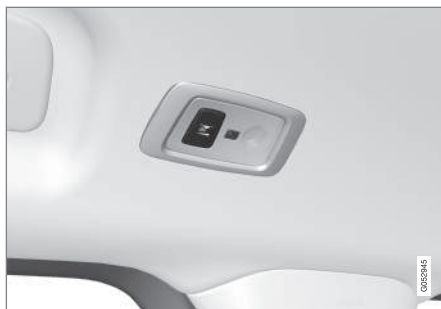
Olvasólámpa a hátsó ülés felett panorámatetővel* felszerelt autókban.
