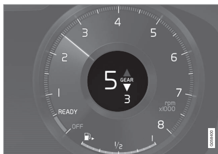
Fokozatváltás-jelző a 12-hüvelyes járművezetői kijelzőn.
