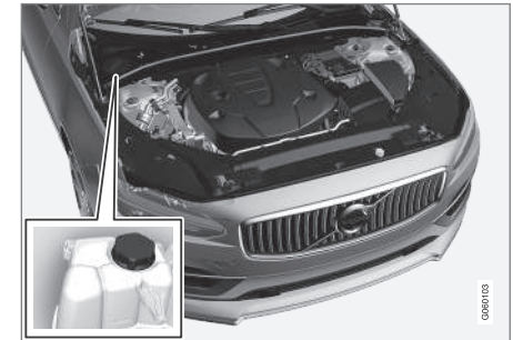
Hűtőfolyadék tágulási tartálya, balkormányos autó.
