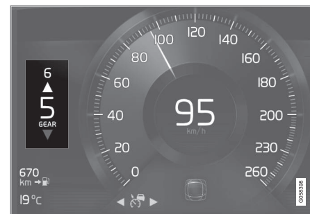
Fokozatváltás-jelző a 8-hüvelyes járművezetői kijelzőn.
