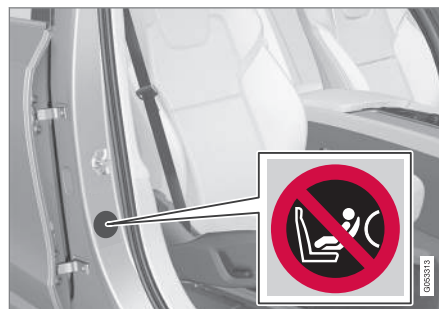
Címke az utas oldali ajtóoszlopon. A légszák címkéje akkor válik láthatóvá, amikor ki van nyitva az utasajtó.
