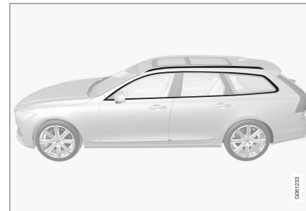
Alkatrészek, amelyek 3,5 és 11,5 pH-érték közötti tisztítószerekkel moshatók.
