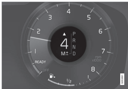
Fokozatváltás-jelző a 12-hüvelyes járművezetői kijelzőn.
