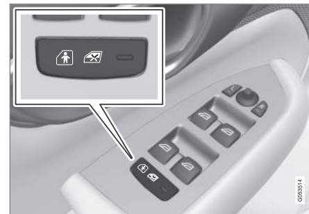
Gomb az elektromos aktiváláshoz/inaktiváláshoz.
