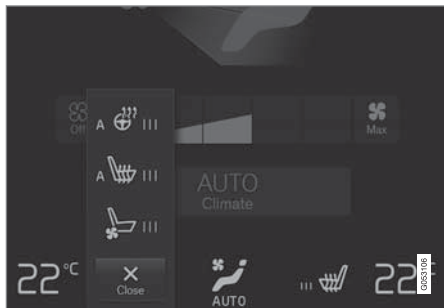
恆溫控制列的方向盤及座椅按鈕。
