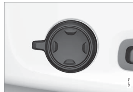
多功能控制器，位於座椅的座部側面。
