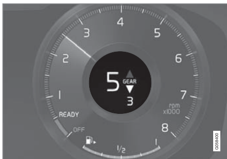
12 吋駕駛人顯示器*中的換檔指示器。
