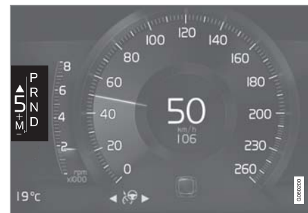
8 吋駕駛人顯示器中的換檔指示器。
