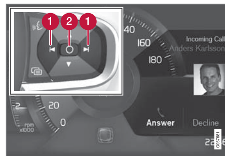
駕駛人顯示器 6 中的訊息與方向盤右側鍵盤。
