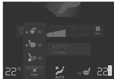
恆溫控制列的方向盤及座椅按鈕。
