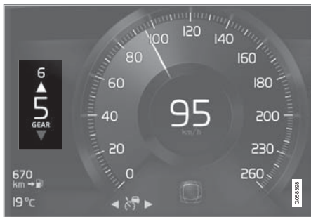
8 吋駕駛人顯示器中的換檔指示器。
