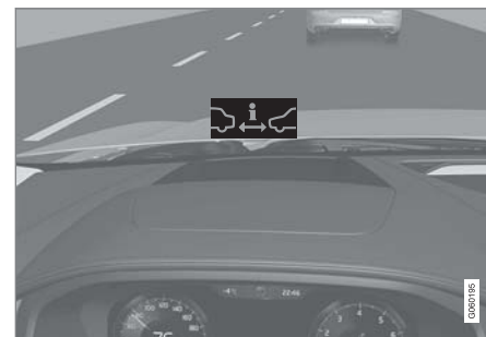
擋風玻璃上的距離警告燈號 39。
