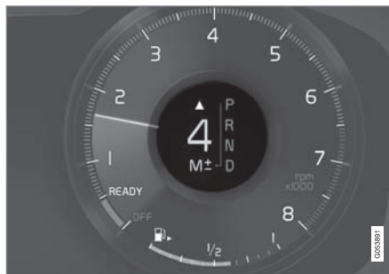
12 吋駕駛人顯示器*中的換檔指示器。
