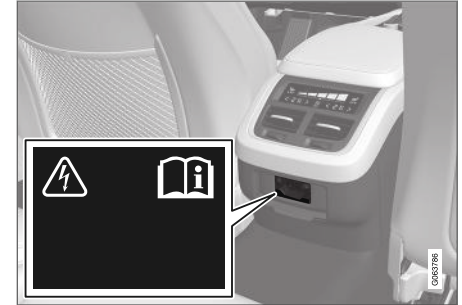
Stroomaansluiting in tunnelconsole, achterin.
