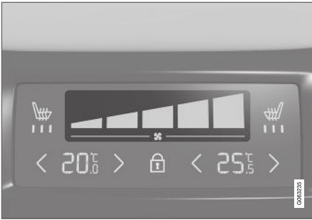
Ventilatorregeling op klimaatpaneel achter op tunnel-console.
