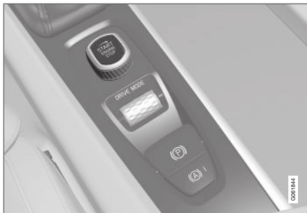
De startknop op de tunnelconsole.
