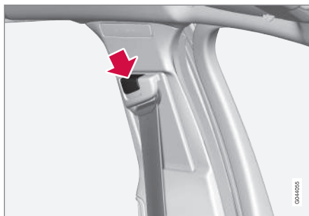
Ajuste vertical do cinto de segurança. Pressione o botão e desloque o cinto na vertical. Coloque o cinto o mais alto possível, sem que o mesmo entre em contacto com o pescoço.
