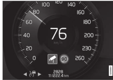
Informação de câmara de velocidade no mostrador do condutor 110 .
