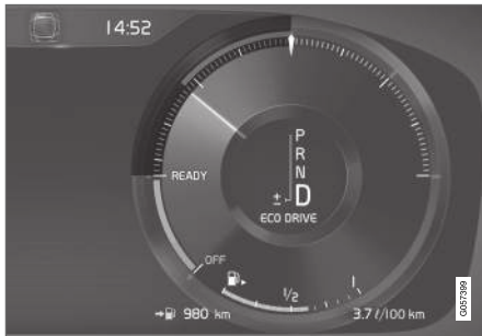
Medidor ECO no mostrador do condutor 12 polegadas*.
