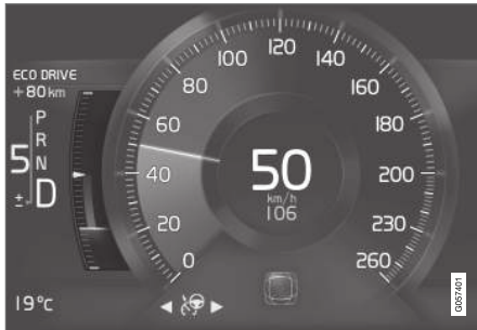
Medidor ECO no mostrador do condutor 8 polegadas.
