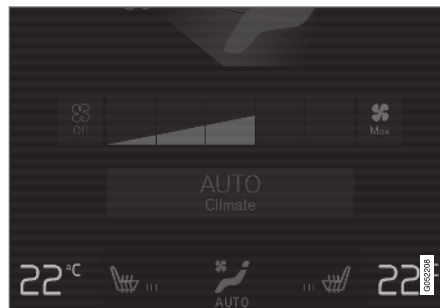
Botões de temperatura na linha da climatização.
