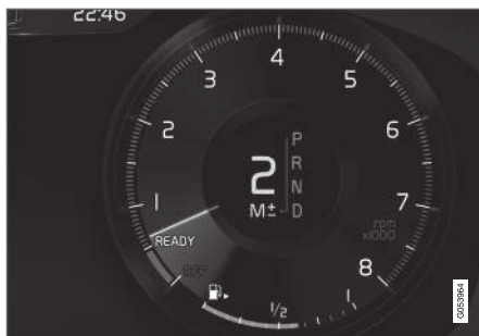
Mostrador do condutor nas mudanças com as alavancas do volante no modo de mudanças manual.
