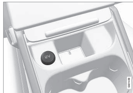
Prise 12 V dans la console du tunnel, sièges avant.
