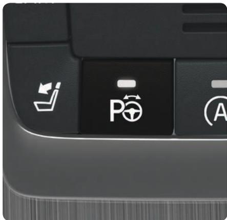
La funzione PAP controlla lo spazio disponibile e sterza l'automobile di conseguenza. Il compito del conducente è sorvegliare accuratamente l'area intorno all'automobile, scegliere la marcia, regolare la velocità e frenare/fermarsi.
