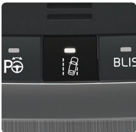
Quando l'automobile sta per superare una striscia di delimitazione, la funzione LKA applica una leggera coppia sterzante sul volante riportando l'automobile nella corsia di marcia. Quando l'automobile supera una striscia di delimitazione, la funzione LKA avverte mediante pulsazioni al volante.
