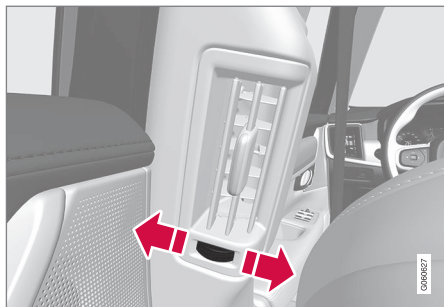
Rolovací kolečko na větracím otvoru 4 .
