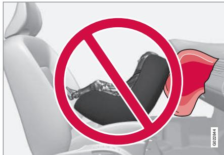
Ne pas placer le siège de bébé sur le siège du passager avant
