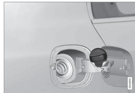
La vapeur d'essence se dilate par temps chaud. Ouvrez le bouchon du réservoir de carburant lentement.
