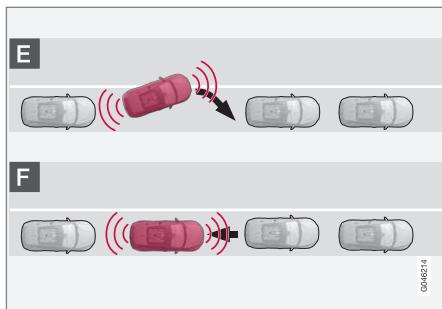
Après que le véhicule a reculé dans l'espacement de stationnement, sa position dans l'espace doit être réglée en roulant légèrement vers l'avant et l'arrière.
