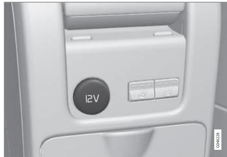
Prise 12 volts dans la console centrale arrière
