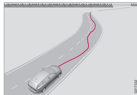
Une caméra surveille les lignes peintes qui délimitent la voie dans laquelle le véhicule roule et compare la direction de la route avec le mouvement du volant. Un signal prévient le conducteur si le véhicule ne suit pas régulièrement la voie.
