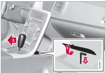
**1** Enlever le tapis de caoutchouc sur le plancher de l'espace de rangement derrière la console centrale pour voir la petite ouverture permettant de désactiver le système de verrouillage du levier de vitesses.
