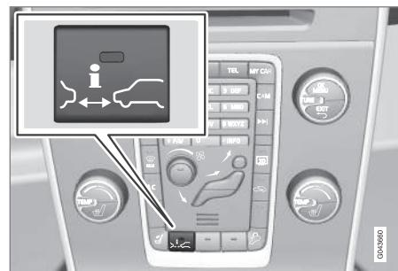
Appuyer sur le bouton au centre du tableau de bord pour activer ou désactiver cette fonction. Le témoin dans le bouton s'allume lorsque cette fonction est active.
