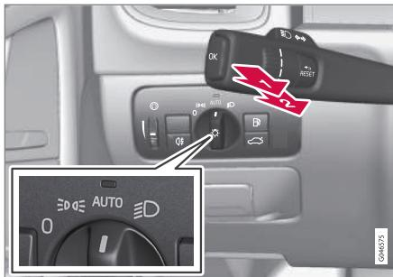
Commutateur de phares et levier de commandes au volant
