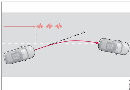
Le système LKA génère des vibrations dans le volant de direction et offre une assistance de direction<sup>11</sup>.
