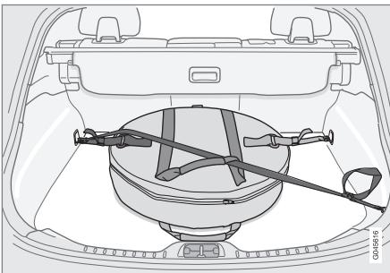
tourner la poignée située sur le sac de la roue de secours vers vous. Fixer les crochets de la courroie cousue dans les oeillets de chargement avant. Fixer la longue courroie dans l'un des oeillets de chargement avant, enrouler la courroie en diagonale par-dessus la roue de secours et à travers la poignée supérieure. Fixer la courroie courte sur la longue courroie. Fixer dans l'oeillet de chargement arrière et serrer.
