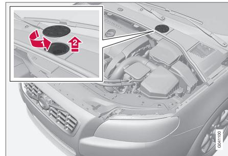
Emplacement du réservoir du liquide de frein
