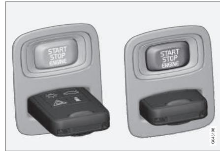
2. Afin de désactiver l'alarme, insérer la clé-télécommande dans la fente d'allumage (également sur les véhicules équipés du démarrage sans clé en option).
