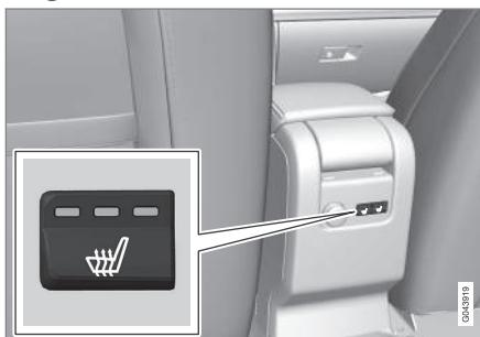
La commande du chauffage des places extérieures s'effectue de la même manière que pour les sièges avant.
