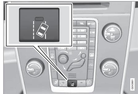
On peut activer ou désactiver le LKA en appuyant sur le bouton de la console centrale. Un témoin dans le bouton s'allume lorsque le système est activé.
