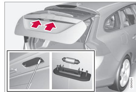
1. Retirer les vis à l'aide d'un tournevis.
