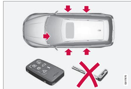
Points de verrouillage/déverrouillage lorsque le verrouillage indépendant est activé.
