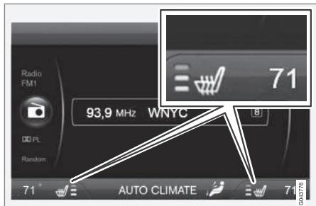
Le réglage de la température actuelle du siège apparaît sur l'écran de la console centrale
