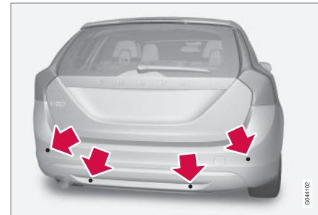
Emplacement des capteurs arrière
