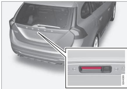
Le hayon est maintenu fermé par un mécanisme de verrouillage électrique. Pour ouvrir :
