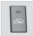
L'air de l'habitacle est alors recirculé, c.-à-d. qu'il n'y a pas d'air de l'extérieur du véhicule qui s'introduit dans la voiture lorsque cette fonction est activée. Le témoin lumineux du bouton s'allume lorsque le recyclage est sélectionné.
