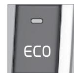
Si la fonction ECO\* est activée, le moteur du véhicule peut s'arrêter automatiquement avant l'arrêt complet du véhicule.
