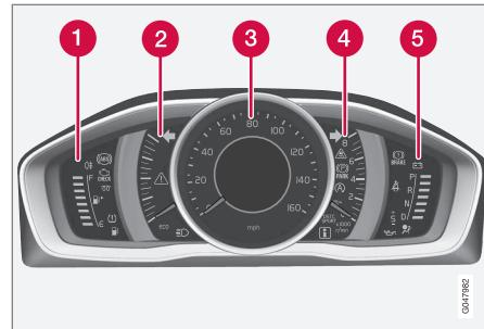
**1** Jauge de carburant : lorsque le témoin affiche un repère blanc<sup>1</sup>, un témoin jaune s'allume pour indiquer un niveau bas de carburant. Voir également Ordinateur de bord - introduction (p. 123) et Remplissage - exigences relatives au carburant (p. 306) pour de plus amples informations.
