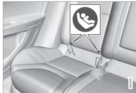
Les symboles figurant sur le revêtement du dossier indiquent les positions des ancrages ISO-FIX/LATCH comme illustré. Pour accéder aux ancrages, s'agenouiller sur le coussin du siège et les repérer au toucher. Toujours suivre les directives d'installation du fabricant du siège pour enfant et utiliser à la fois les ancrages inférieurs ISOFIX/LATCH et les attaches supérieures (p. 60) dans la mesure du possible.
