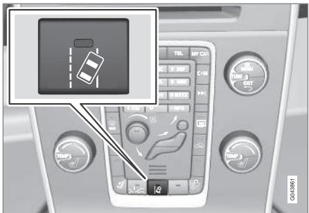
On peut activer ou désactiver le LDW en appuyant sur le bouton de la console centrale. Un témoin dans le bouton s'allume lorsque le système est activé. Ceci est complété par les affichages graphiques dans le tableau de bord, par exemple :
