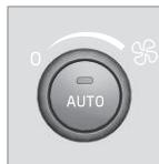
Tourner la commande dans le sens horaire pour augmenter la vitesse du ventilateur et dans le sens antihoraire pour la diminuer. Si la commande
