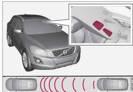
Emplacement du capteur laser dans le pare-brise<sup>5</sup>
