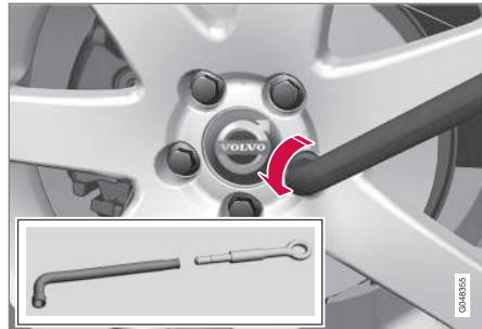
6. Avec le véhicule toujours au sol, retirer les caches en plastique des écrous de roue au moyen de l'outil fourni et utiliser la clé à roue/l'œillet de remorquage pour desserrer les écrous de roue d' $\frac{1}{2}$  à 1 tour en exerçant une pression vers le bas (dans le sens anti-horaire).
