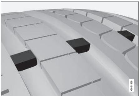
Les lettres **TWI** sont imprimées sur le flanc du pneu. Lorsqu'il ne reste plus qu'environ 1,6 mm (1/16 po) de semelle, les bandes deviennent visibles et indiquent qu'il faut remplacer le pneu. Un pneu dont l'épaisseur de la semelle est inférieure à 1,6 mm (1/16 po) offre une très mauvaise adhérence.
