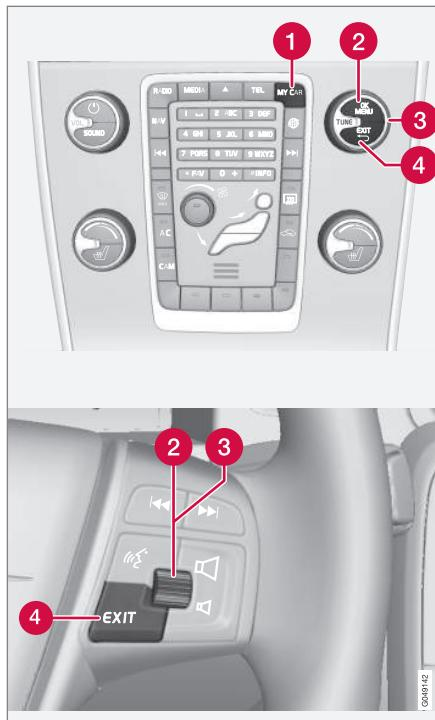
Le panneau de commande de la console centrale et le clavier du volant. L'illustration est générique et l'aspect ainsi que l'emplacement des boutons peut varier.
