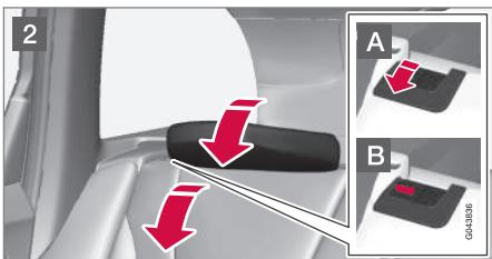
**1** Déverrouiller et abaisser l'appuie-tête central (voir Sièges arrière - appuie-tête (p. 90)) si la section centrale et/ou droite du dossier doit être abaissée. Les appuie-tête latéraux se replient automatiquement.
