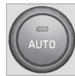
Si vous sélectionnez une ou plusieurs fonctions manuelles, les autres fonctions continuent d'être commandées automatiquement. Le capteur de qualité de l'air (p. 135) est activé et tous les réglages manuels sont désactivés lorsqu'on appuie sur **AUTO**. Le message **CLIM AUTOMATIQUE** apparaît dans l'affichage.
