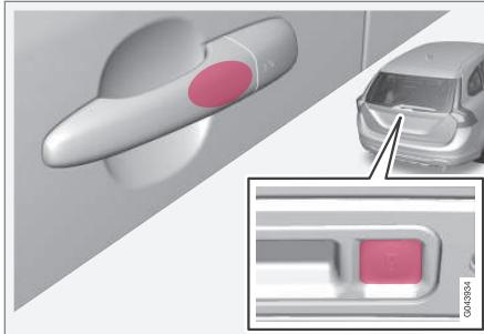
Les modèles équipés du démarrage sans clé possèdent une zone sensible à la pression sur les poignées de portières extérieures et un bouton couvert de caoutchouc près de la commande d'ouverture du hayon.
