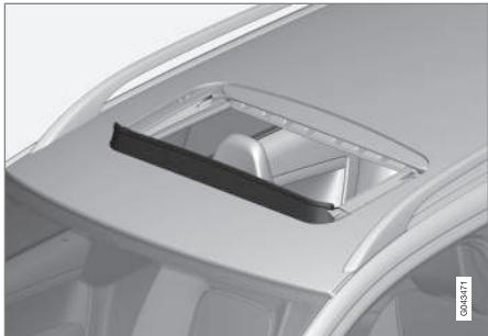
Le toit ouvrant est équipé d'un coupe-vent qui se plie lorsque le toit ouvrant est ouvert.
