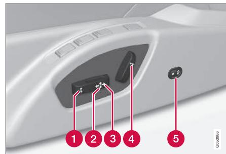
Commandes de réglage de siège électrique
