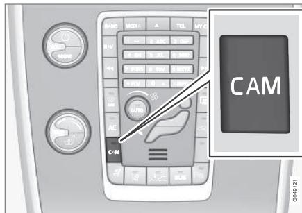
La PAC est activée lorsqu'on déplace le levier de vitesses à **R** si le système est sélectionné dans le système de menu **MY CAR** ou si on appuie sur le bouton **CAM** dans la console centrale. Voir My Car (ma voiture) - introduction (p. 81) pour une description du système de menu.
