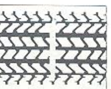
Slijtageprofiel vóór, normale slijtage
