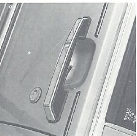
De centrale vergrendeling wordt vanaf het bestuursportier bediend.
