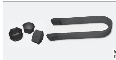
Plastikinių dangtelių nuėmimo nuo ratų varžtų įrankis.
