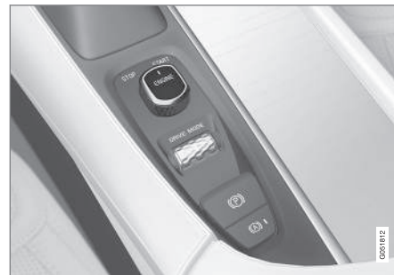
Užvedimo rankenėlė tunelineame valdymo pulte.
