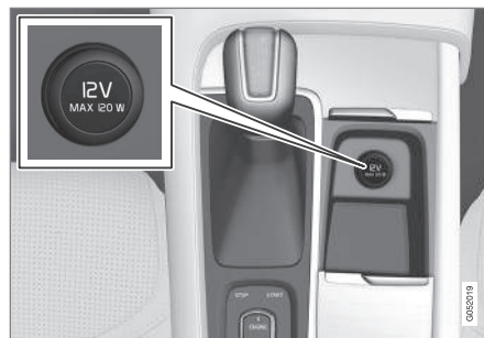
12 V elektros lizdas tuneliniam valdymo pulte, priekinėje sėdynėje.
