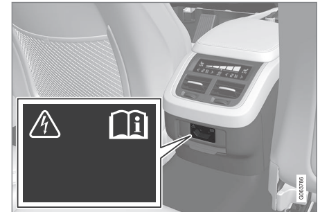
Stroomaansluiting in tunnelconsole, achterin.
