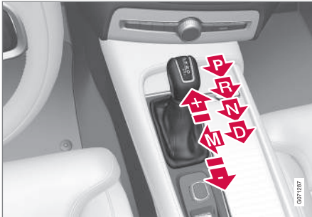
Overzicht grote schakelhendel en schakelstanden.
