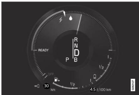
O motor elétrico não pode fornecer a quantidade de energia solicitada e o motor a combustão interna arranca.
