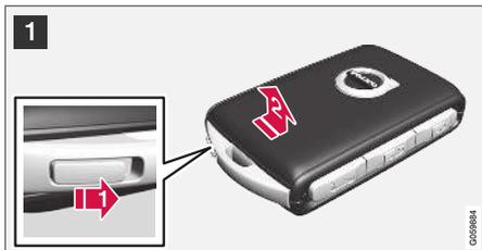
**1** Segure a chave do controle remoto com a frente visível e a logo Volvo para o lado direito. Deslize o botão na extremidade de baixo do anel da chave para a direita. Deslize a proteção lateral dianteira alguns milímetros para cima.
