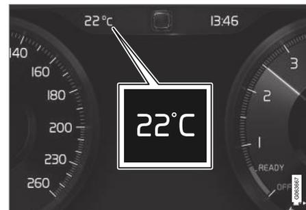
O medidor de temperatura externa pode mostrar um valor de temperatura muito alto após o veículo ter estado parado.
