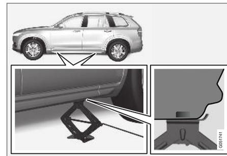
9. Coloque o macaco sobre uma superfície plana, sólida e não escorregadia sob o ponto de fixação a ser usado.
