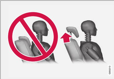
O apoio de cabeça do lugar central deve ser regulado de acordo com a altura do passageiro, cobrindo preferencialmente toda a nuca. Desloque manualmente para cima conforme a necessidade.
