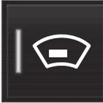
Pressione o botão **Head-up display** na visualização de função do visor central. Uma indicação no botão acende quando a função está ativada.
