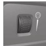
Com o seletor rotativo no painel de instrumentos, à esquerda do volante, ajusta-se a intensidade da luz da iluminação do visor, a iluminação dos controles a luz ambiente e a iluminação ambiente\*
