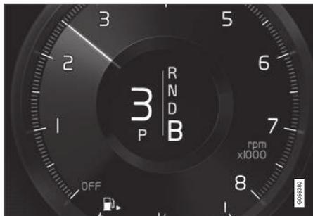
A partir da posição **B**, é possível reduzir a marcha gradualmente para marchas menores. A posição **B** pode ser selecionada a qualquer momento durante a condução. O veículo freia usando seu motor elétrico quando o pedal do acelerador é liberado, enquanto também carrega a bateria híbrida. Isso proporciona mais oportunidades de recarregamento da bateria híbrida, à medida que o carregamento ocorre mesmo sem o motorista utilizar o pedal do freio.
