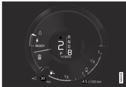
O veículo gera corrente para a bateria e a bateria é carregada, por exemplo, com ligeiras pressões no pedal do freio ou com frenagem com o motor em descidas.
