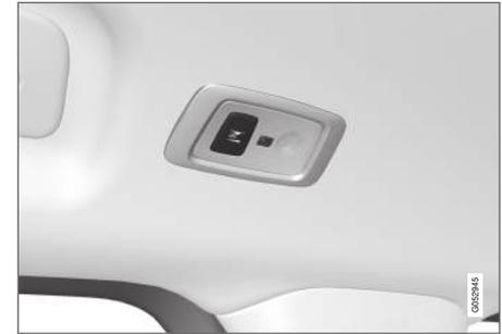
Em veículos com teto panorâmico\*, existem duas unidades de lâmpadas, uma em cada lado do teto.<sup>7</sup>
