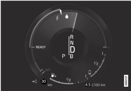
Visor do motorista em condução tanto com o motor elétrico como com o motor a combustão interna.
