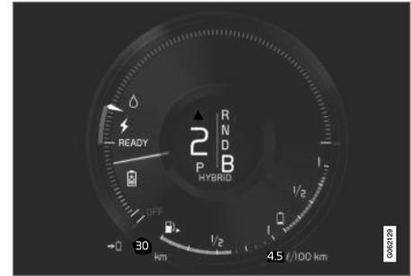
O visor do motorista indica carregamento na frenagem com o motor elétrico.
