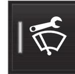
Pressione o botão **Pos. serviço do limp. para-brisa**. O indicador luminoso no botão acende quando o modo de serviço está ativado. Quando ativados, os limpadores se movem para a posição de serviço. Para desativar o modo de serviço, pressione uma vez em **Pos. serviço do limp. para-brisa**. O indicador luminoso no botão apaga quando o modo de serviço está desativado.
