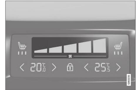
Controle do ventilador no painel de climatização traseiro no console de túnel.
