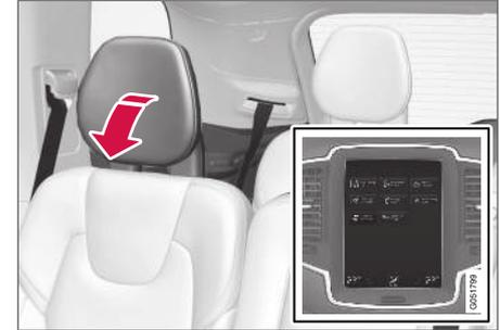
Os apoios de cabeça laterais podem ser rebatidos pela visualização de função no visor central. O rebatimento do apoio de cabeça pode ser feito na posição de ignição **0**.
