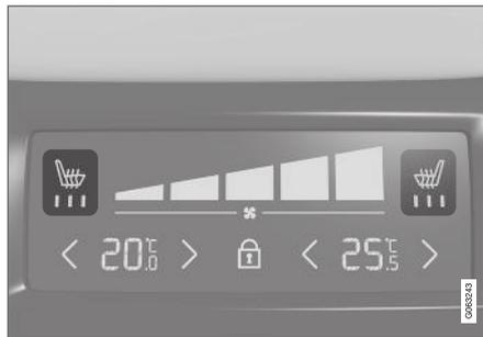
Indicação e controle do banco aquecido no painel de climatização na parte de trás do console do túnel.
