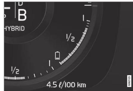
A energia na bateria híbrida é usada para o motor elétrico, mas também para esfriar ou aquecer o veículo. O computador de bordo calcula uma distância aproximada da energia restante na bateria híbrida.
