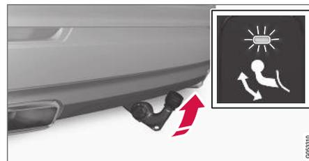
> A barra de reboque rebate e desce para uma posição não bloqueada - a luz indicadora pisca em laranja. O gancho de reboque está pronto para continuar a se mover para a posição travada.
