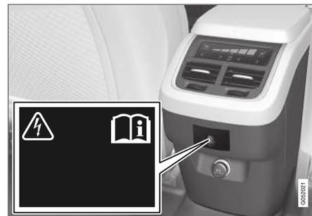
Tomada elétrica no console de túnel, segunda fileira de bancos.
