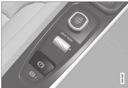
O controle do freio de estacionamento está localizado no console do túnel, entre os bancos.
