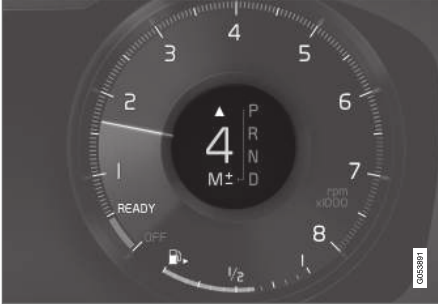
12 inç sürücü ekranındaki vites değiştirme göstergesi*.
