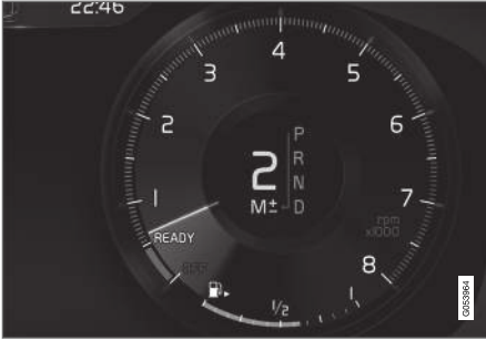
sürücü gösterge ekranındaki manuel vites değiştirme modu 3
