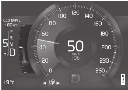
8 inç sürücü gösterge ekranındaki Eco göstergesi.
