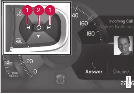
Sürücü gösterge ekranı 6 ve direksiyon simidi sağ tuş takımındaki mesaj.
