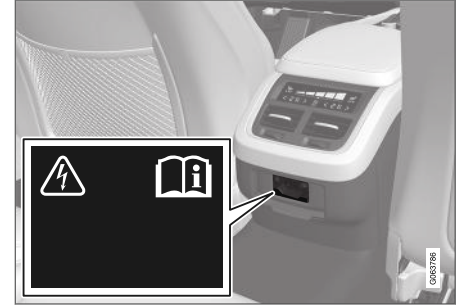
Tünel konsolundaki elektrik soketi, arka koltuk.
