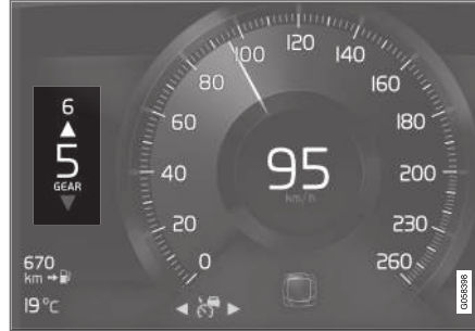
8 inç sürücü göstergesi ekranındaki vites değiştirme göstergesi.
