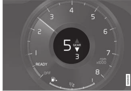
12 inç sürücü ekranındaki vites değiştirme göstergesi*.
