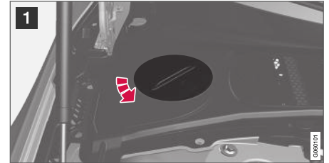
Soğutma sıvısı genleşme kabı, soldan direksiyonlu araç.
