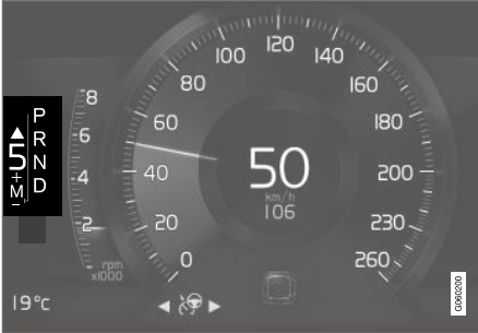
8 inç sürücü göstergesi ekranındaki vites değiştirme göstergesi.
