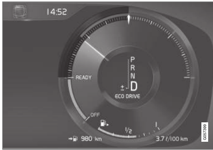
12 inç sürücü ekranındaki Eco göstergesi*.
