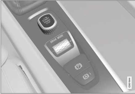
Tünel konsolundaki çalıştırma düğmesi.
