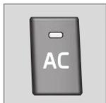
Quando a lâmpada no botão **AC** está acesa todo o ar condicionado do sistema é controlado automaticamente.
