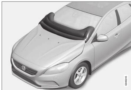
O airbag para os peões (Pedestrian Airbag) encontra-se montado sob o capot, junto ao pára-brisas. Perante algumas colisões frontais com um peão reagem os sensores no pára-choques dianteiro e o airbag é insuflado caso a violência da colisão assim o determine. Os sensores estão ativos a uma velocidade entre 20-50 km/h (12-30 mph) e com uma temperatura exteriores entre -20 e +70 °C.
