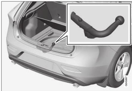
Quando não utilizado, o engate de reboque amovível deve ser guardado no bloco de espuma<sup>18</sup> sob o chão da carga.
