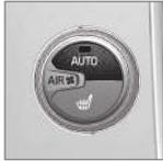
A função auto comanda automaticamente a temperatura (pág. 137), o ar condicionado (pág. 138), a velocidade do ventilador (pág. 136), a recirculação (pág. 139) e a distribuição de ar (pág. 131).
