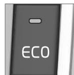
Se a função ECO estiver activada o motor pode parar automaticamente antes do automóvel estar imobilizado.
