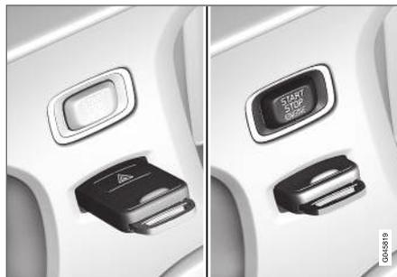
Interruptor de ignição com o comando à distância ejetado/inserido.
