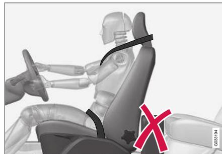
Não coloque qualquer objecto no piso atrás do assento do condutor/passageiro que possa evitar o funcionamento do sistema WHIPS.
