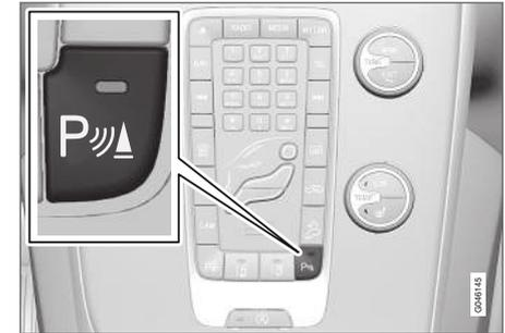
Lig/Desl dos sensores da Assistência ao estacionamento e do CTA<sup>37</sup>.
