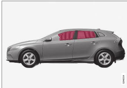
A cortina de colisão IC (Inflatable Curtain) é parte integrante do sistema SIPS (pág. 38). Esta encontra-se montada ao longo de ambos os lados do forro do tecto e ajuda a proteger o condutor e os passageiros nos lugares laterais do automóvel. Perante uma colisão suficientemente forte, os sensores reagem e a cortina de colisão é insuflada.
