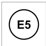
E5 é uma gasolina com um máximo de 2.7 % de oxigénio e um máximo de 5 vol % de etanol.
