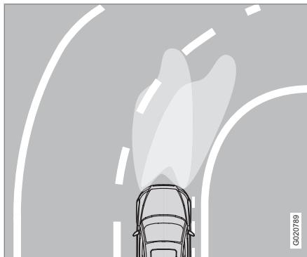
Modèle d'éclairage avec ABL désactivé (gauche) et activé (droite)
