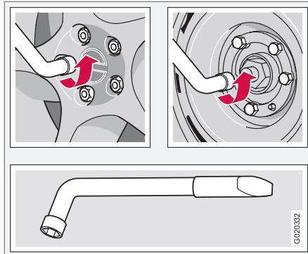
5. Lorsque le véhicule est toujours au sol, utiliser le démonte-roue pour desserrer les écrous de roue en tournant 1/2-1 tour et en exerçant une pression vers le bas. Tourner
