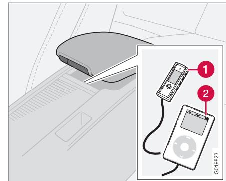
Un dispositif auxiliaire, comme un iPod®, un lecteur MP3 ou une clé USB, peut être branché à la chaîne audio au moyen du connecteur dans l'espace de rangement de la console centrale. On peut faire passer un câble standard d'un iPod® ou d'un lecteur MP3 sous le couvercle jusqu'au connecteur AUX dans l'espace de rangement.
