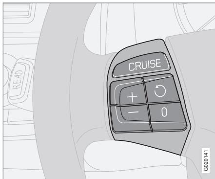
Les commandes du régulateur de vitesse sont situées à gauche de la partie centrale du volant.
