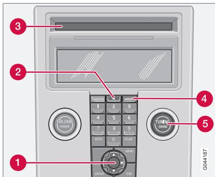
**1** MENU NAVIGATION CONTROL-appuyer sur les flèches vers le haut ou le bas pour faire défiler un menu ou sur les touches situées sur le côté gauche ou droit de la commande pour effectuer un changement de piste dans un CD ou un défilement avant/arrière rapide.
