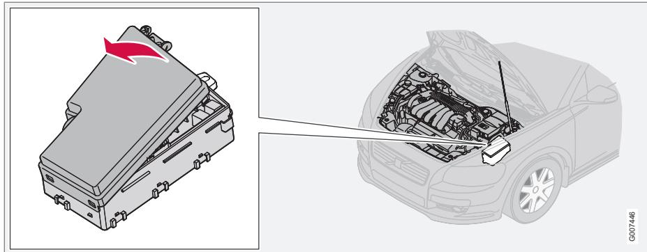
Le boîtier dans le compartiment moteur contient 36 fusibles.
