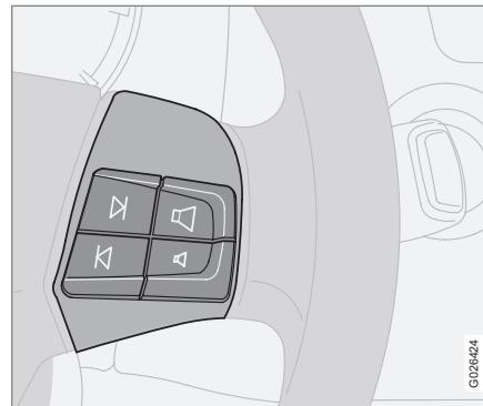
Clavier monté sur le volant
