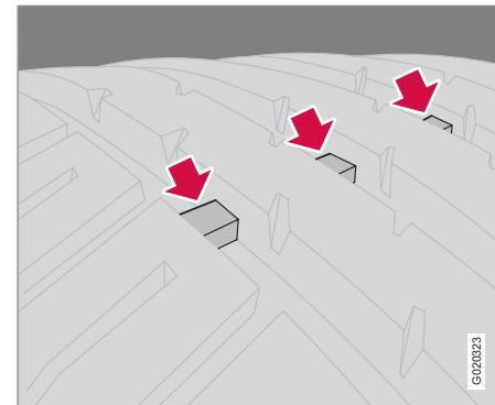
Les pneus sont munis de bandes indicatrices d'usure perpendiculaires ou parallèles à la semelle. Les lettres **TWI** sont imprimées sur le flanc du pneu. Lorsqu'il ne reste plus qu'environ 1,6 mm (1/16 po) de semelle, les bandes deviennent visibles et indiquent qu'il faut remplacer le pneu. Un pneu dont l'épaisseur de la semelle est inférieure à 1,6 mm (1/16 po) offre une très mauvaise adhérence.
