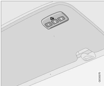
Le système de commande sans fil HomeLink<sup>1</sup> permet de remplacer jusqu'à trois émetteurs à fréquence radio (FR) portatifs utilisés pour faire fonctionner des dispositifs comme le dispositif de commande de porte, l'ouvre-porte de garage, le dispositif de verrouillage de porte d'entrée, le système de sécurité et même l'éclairage domestique. Pour de plus amples renseignements sur le HomeLink, visitez le site Web suivant : [www.homelink.com](http://www.homelink.com).
