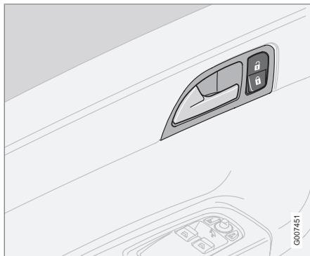
Le commutateur près de la poignée de la portière du conducteur peut être utilisé pour verrouiller ou déverrouiller toutes les portières et le hayon, ouvrir les vitres latérales<sup>1</sup> et régler l'alarme.
