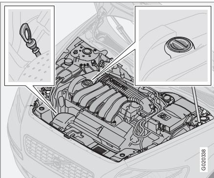
Emplacement de la jauge et du bouchon de remplissage
