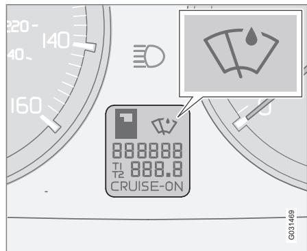
Le capteur de pluie règle la vitesse des essuie-glaces selon la quantité d'eau sur le pare-brise. La sensibilité du capteur de pluie est ajustée en déplaçant la molette (C dans l'illustration de la page précédente) vers le haut (les essuie-glaces balaieront le pare-brise plus fréquemment) ou vers le bas (les essuie-glaces balayeront le pare-brise moins fréquemment).
