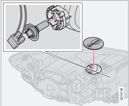
Ampoule halogène de feu de route
