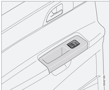
Les vitres électriques des portières arrière peuvent être manoeuvrées au moyen de la commande de chaque portière arrière et du commutateur de la portière du conducteur.
