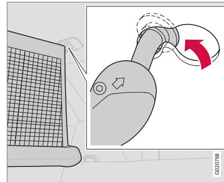
La Volvo V50 peut être équipée d'un filet d'arrimage en nylon résistant qui peut être utilisé lorsque les dossier des sièges arrière sont redressés ou rabattus.
