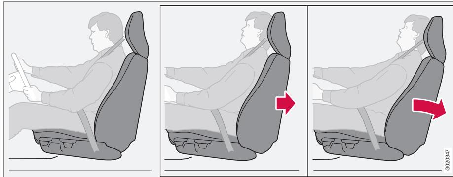
Le système WHIPS consiste en des charnières et des supports de conception spéciale situés dans le dossier des sièges avant, et destinés à absorber une partie de l'énergie produite par une collision arrière (emboutissage).
