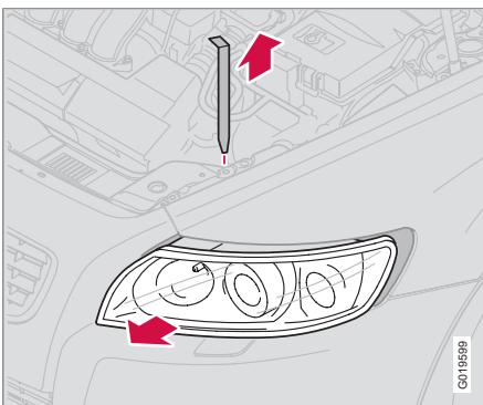
Il faut enlever le boîtier du phare complet lorsqu'on remplace les ampoules des feux de croisement/route, des feux de stationnement, des
