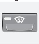
Pointe le débit d'air sur le pare-brise et les vitres latérales et augmente la vitesse du ventilateur.
