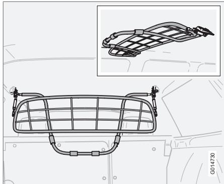
La grille d'acier permet d'éviter que les objets transportés dans l'espace de chargement soient projetés dans l'habitacle en cas de freinage brusque.
