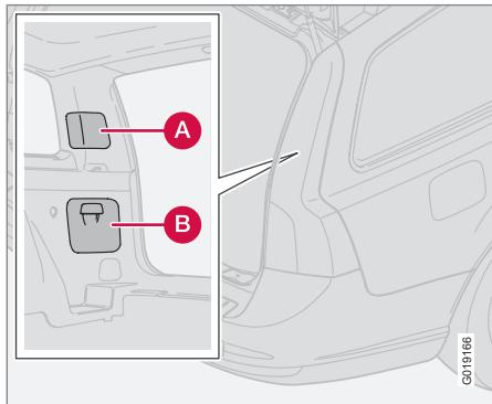
Toutes les ampoules du bloc de feux arrière peuvent être remplacées à partir de l'espace à bagages. Pour accéder aux supports d'ampoule :
