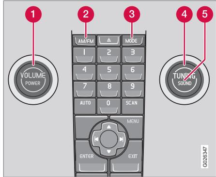
**1** Bouton rotatif **VOLUME****2** **AM/FM** - sélectionner une bande radio**3** **MODE** - sélectionner une source sonore**4** Bouton rotatif **TUNING****5** Touche **SOUND**
