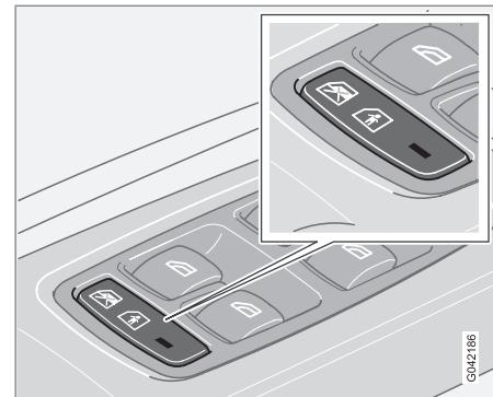
Interrupteur de verrouillage
