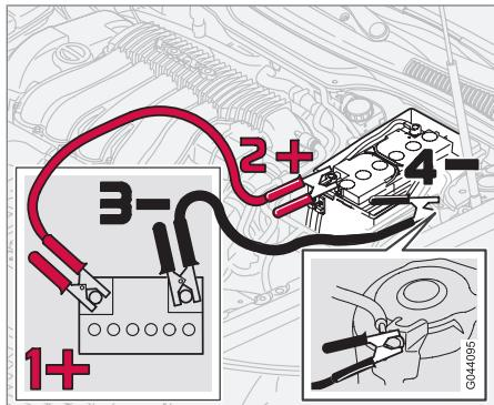
Suivre ces instructions pour charger la batterie de votre véhicule, ou celle d'un autre véhicule, au moyen d'une batterie auxiliaire. Si la batterie auxiliaire de 12 volts à utiliser est sur un autre véhicule, il faut vérifier que les véhicules ne se touchent pas pour éviter une fermeture prématuree du circuit. S'assurer de suivre les instructions d'utilisation de la batterie auxiliaire de l'autre véhicule.
