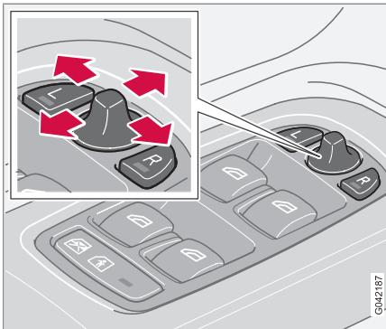
Les interrupteurs des commandes des rétroviseurs se situent sur l'accoudoir de la porte du conducteur.
