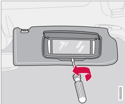
1. Insérer doucement un tournevis au centre de la partie inférieure du miroir et dégager délicatement les crampons sur les côtés du verre.
