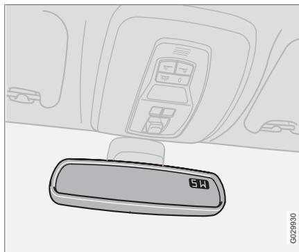
Le coin supérieur droit du rétroviseur comprend un écran intégré qui indique la direction du véhicule. Huit directions différentes peuvent être affichées : **N, NE, E, SE, S, SO, O** et **NO**. L'écran montre l'orientation de votre véhicule par rapport au nord géographique.
