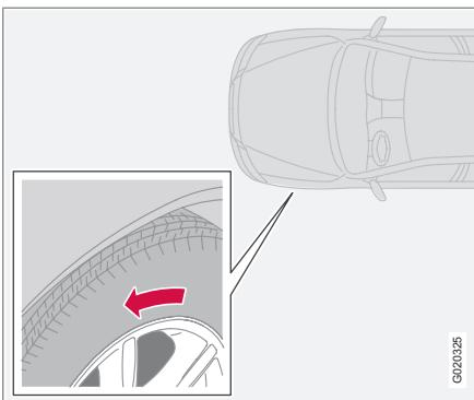
Les flèches indiquent le sens de rotation du pneu
