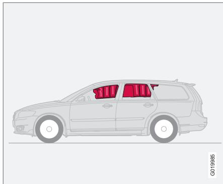
Ce dispositif est composé de rideaux gonflables situés le long de la paroi latérale des garnitures de toit, qui vont du centre des deux vitres latérales avant au bord arrière des vitres latérales arrière. Il vise à protéger la tête des occupants des sièges avant et celle des occupants de chaque côté du siège arrière dans certaines collisions latérales.
