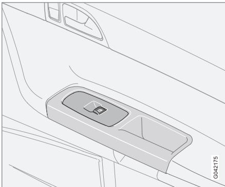
La commande de la vitre électrique sur la porte du côté passager fait fonctionner uniquement cette vitre.
