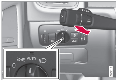
Levier au volant et commutateur d'éclairage en position AUTO .
