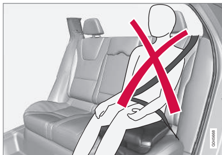
位置不正確：頭枕必須調整到與頭同高，且安全帶不可置於肩膀之下。
