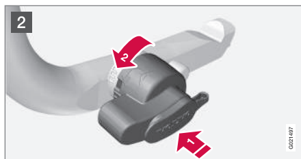
2 Apriete la rueda de cierre 1 y gírela en sentido contrahorario 2 hasta que se oiga un "clic".
