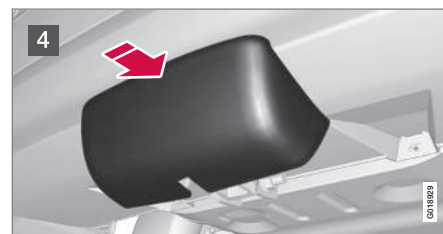
4 Empuje la cubierta de protección hasta que quede enganchada.
