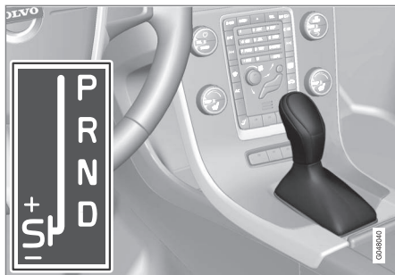
D: Automatiske gearpositioner. +S- : Manuelle gearpositioner. S: Sport-position*.
