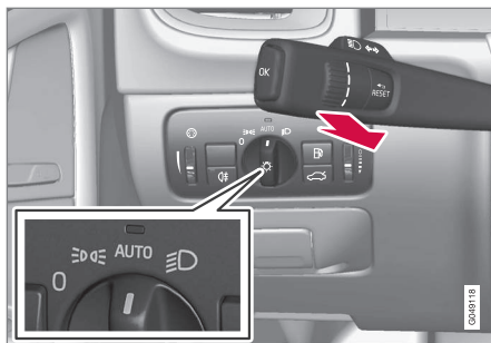
Kontaktarm og lyspanelets knap i position AUTO .
