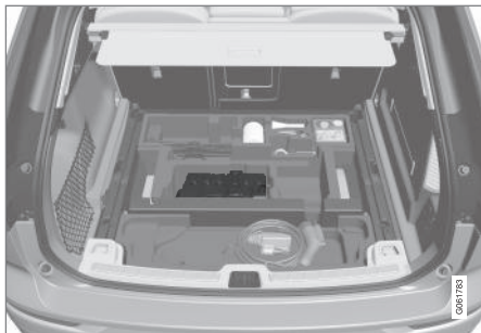
Käynnistysakku on sijoitettu kuormatilaan.
