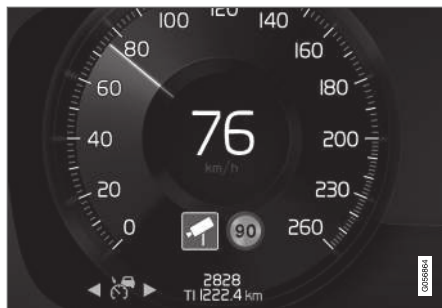
Information de radar dans l'écran du conducteur.
