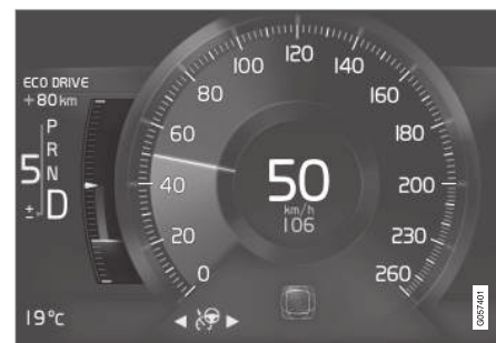
Indicateur Eco dans l'écran du conducteur de 8 po.
