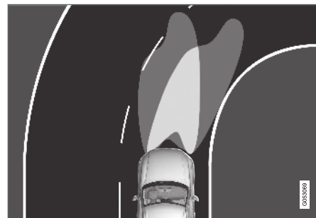
Motif de phare avec fonction désactivée (à gauche) et activée (à droite).
