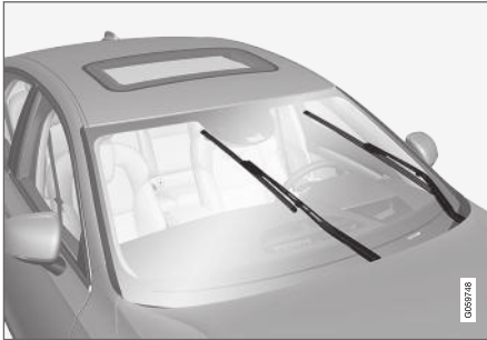
Balais d'essuie-glaces en position d'entretien.
