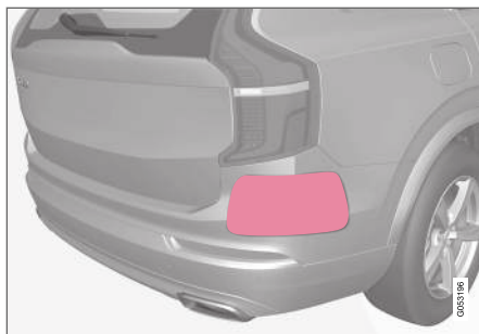
Emplacement des capteurs radar. Maintenir propre la surface indiquée – des côtés gauche et droit de la voiture.
