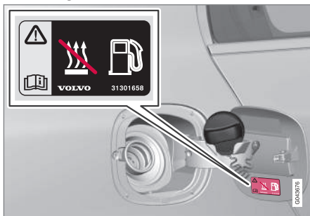
Varningsdekal på tankluckan.
