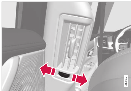
Rueda selectora de la tobera de ventilación 2 .
