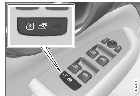
Botón de conexión y desconexión eléctrica.
