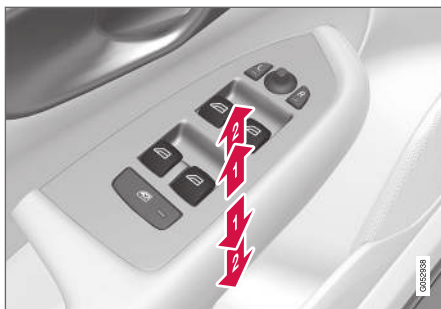
Accionamiento de los elevalunas eléctricos.
